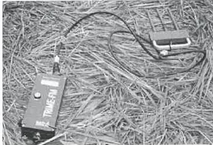
→ Mesure la résistance au courant pour connaître le volume d'eau dans le sol
