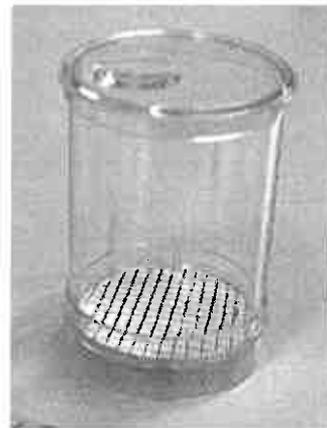
L'appareil est un système de filtration sous pression réduite (trompe à eau). Il contient un support filtre qui reçoit, sur une partie en inox fritté à larges pores, la membrane de filtration.
